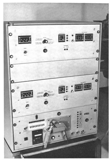
Abbildung 4 Lochstreifenleser und Nadelsteuergeräte mit Schaltern für eine schnelle Musteränderung
