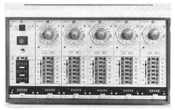
Steuergerät zu Garnreinigungsanlage Uster Automatic®, Modell D
