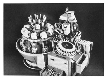
Schweiter-Coner CA 12 mit automatischer Kopszuführung
