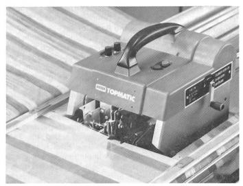
Webkettenknüpfmaschine Uster® Topmatic
