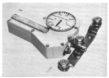
Abbildung 2 Fadenspannungsmesser Type DXX mit Luftdämpfung
