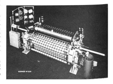
weise von oberer Kettablassvorrichtung demonstriert, die den für die Searsuckerfalte notwendigen, gleichmässigen Vorlauf in jeder Phase garantiert.
