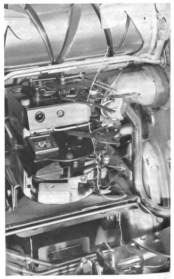
Bei der Splice-Verbindung werden die zwei Fadenenden übereinandergelegt, mit einem gezielten Luftstrom verwirbelt und so verdichtet, dass der Fadendurchmesser an dieser Stelle etwa nur das 1,2-fache vom normalen Garndurchmesser ist. Die Festigkeit dieser Verbindung liegt bei 85 % der Garnfestigkeit.
