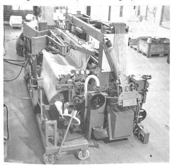
Kettbaum-Hubwagen mit Schwenk-Geschirr-Einlege-Vorrichtung für Rüti-Webmaschinen mit Oberbau.
