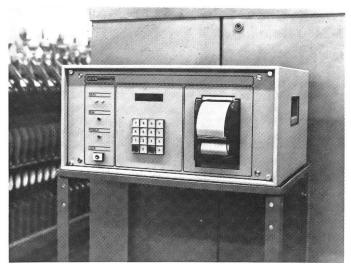
Zentraleinheit des Datensystems Uster® Ringdata
