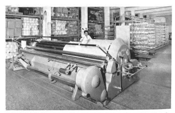
Abbildung 2 Konus-, Schär- und Bäummaschine DSB mit automatischem Knotgatter
