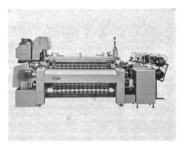
Im Greifersektor wird Rüti erstmals seine neu entwickelte Greiferwebmaschine Typ 2001 präsentieren. Die Greiferköpfe werden auf Stahlbändern, die im Fach nicht geführt werden müssen, in das Fach getragen. Es können beliebig wechselbar 8 Schussfarben oder Garnsorten eingetragen werden. Diese neue Maschine bringt neben einer Ausweitung des Anwendungsgebiets, wie Webbreite, Schäftezahl, Spezialausführung für Frottier, vor allem eine beträchtliche Leistungssteigerung.
