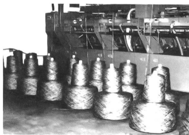
Zuführen des Garnes ab Konen, Kuchen oder ab Dämpfanlage in die Wickelmaschine
