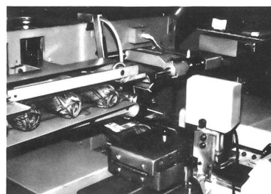
Banderolieren der Knäuel unmittelbar nach dem Wickeln
