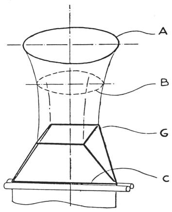
Das Konstruktionsprinzip kann so beschrieben werden: Die kreisrunde Stoffbahn wird in eine viereckige verwandelt, wobei das Längen- zum Breitenmass mittels Teleskopstangen und Gelenken variiert werden kann. Von diesem Viereck läuft dann der Stoff keilförmig unter gleichzeitiger Verbreiterung nach unten in die Abzugswalzen ein
