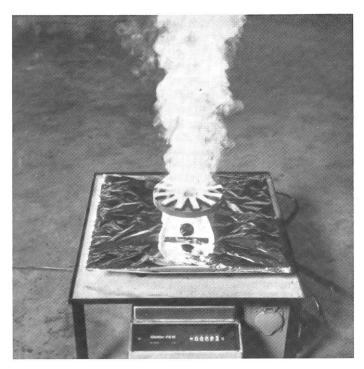
Die dabei verwendeten Brennstoffe müssen jeweils vergleichbare Eigenschaften (Feuchtegehalt) aufweisen. Sie werden zuerst genau gewogen, unter kontrollierten Bedingungen sodann auf einer Spezialwaage gezündet und verbrannt, so dass auch das Abbrandgewicht in Funktion der Zeit gemessen werden kann.
