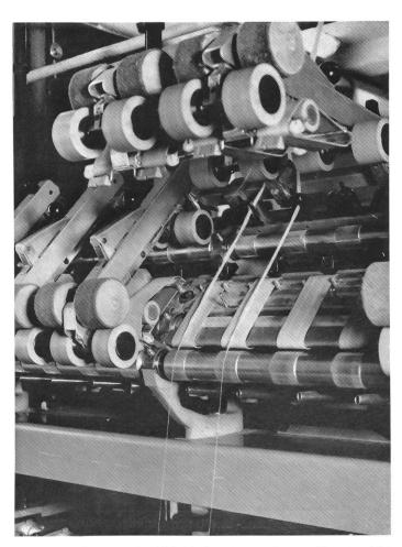
Langstapel-Streckwerk K2R-M für ein erweitertes Einsatzgebiet
