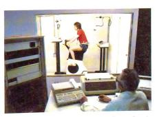
Abb. 9 Kontrollierter Trageversuch von Sporthemden im Klimaraum; Ergometerstand mit Prozeßrechne
