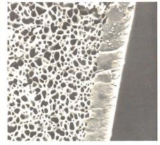
Abb. 3 Dunova-Mantel und Porensystem mit Rasterelektronenmikroskop abgebildeter Faserguerschnitt
