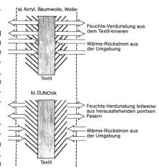
Abb. 15 Modell-Vorstellung des Trocknungsvorgangs unterhalb der sog. Knickpunkt-Feuchte\*):
