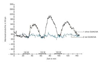
Abb. 16 Wärmestromdichte-Messungen zum Nachweis von überschüssigem Schweiß auf der Haut im Komfortvergleich zweier Sporthemden (1) und (2). Die Peaks der Wärmestromdichtemessungen zeigen: ohne Dunova bleibt viel überschüssiger Schweiß auf der Haut. Mit Dunova bleibt wenig überschüssiger Schweiß auf der Haut
