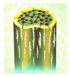
Abb. 1 Modell einer porösen Kern/Mantel Faser
