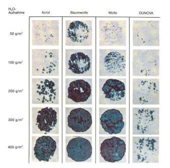
Abb. 12 Abdrucke von vergleichbar konstruierten R/R-Gestricken auf Feuchte-Indikatorpapier nach Wasseraufnahme von einer Sinterglas-Platte bei 34° C
