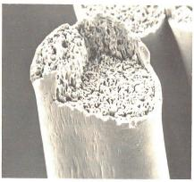
Abb. 2 Dunova-Faser, mit Rasterelektronenmikroskop abgebildeter Gefrierbruch
