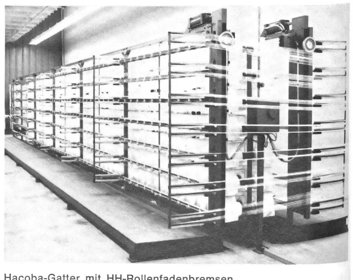
Hacoba-Gatter mit HH-Rollenfadenbremsen
