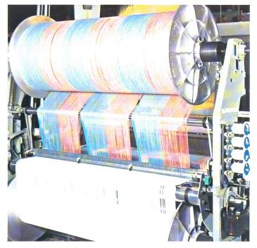
Das Kettablass-System der «terry-matic»-Frottierwebmaschine.
