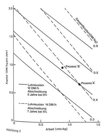
wirkt, dass die Geraden steiler werden, wie dies die Abbildung illustriert. Die verschiedenen Einzelprozesse werden durch Einzelpunkte auf den Geraden dargestellt.
