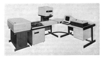
Abbildung 2 Pretema-4003 — Eine voll ausgebaute Farbmess-, Rezeptier- und Datenverarbeitungsanlage (mit Messkopf für Remissions- und Transmissions-Messungen, Kontrollpult und Arbeitstisch, integriertem 16 K/20 bit-Rechner, 5 Mio bytes-Doppelplattenspeicher für Programme und Daten, Display mit Eingabetastatur, 200 cps-Schnelldrucker, Pretema Color Software-Paket In der Programmsprache «Basic».
