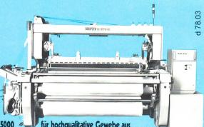
Luftdüsenwebmaschine RÜTI te Strake L5000 für hochqualitative Gewebe aus
