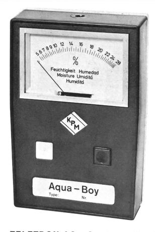
Elektronisches Feuchtigkeitsmessgerät für die Textilindustrie
