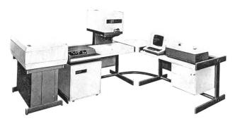
PRETEMA-4003, vollausgebautes Farbmess-, Rezeptierund Datenerfassungs-System bestehend aus: dem neuen Interferenzfilter-Spektralphotometer FS-4, integriertem 16-k-Rechner, externem Massenspeicher (Dual-Disk 5 Mio. bytes), Datensichtgerät mit Eingabetastatur und einem 200-cps-Schnelldrucker.
