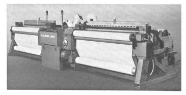
Saurer 500 - Zweiphasen-Greiferwebmaschine mit hoher Leistung
