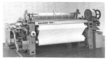
Abbildung 1 Schützenwebmaschine S-100/2
