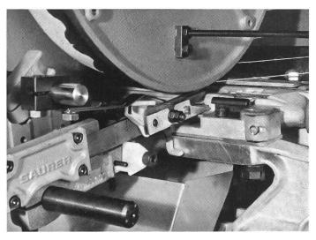
Abbildung 6 Klemmschere am Spulenwechselautomat
