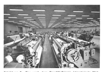
Abbildung 8 Der nach dem Condifil-Prinzip klimatisierte Websaal T5 mit 96 Sulzer-Einfarbenwebmaschinen mit Exzentermaschine in Nennbreiten von 130" (330 cm) und 153" (389 cm). Die Abluft wird über die Oeffnungen in der Websaaldecke abgesaugt.
