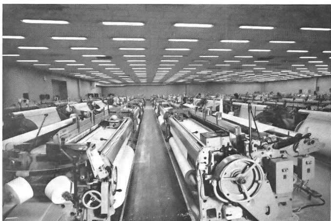
Abbildung 8 Der nach dem Condifil-Prinzip klimatisierte Websaal T5 mit 96 Sulzer-Einfarbwebmaschinen mit Exzentermaschine in Nennbreiten von 130" (330 cm) und 153" (389 cm). Die Abluft wird über die Oeffnungen in der Websaaldecke abgesaugt.
