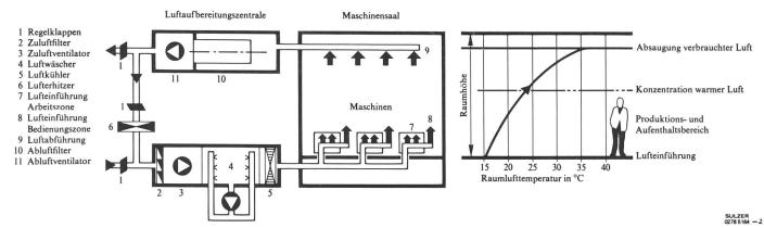
Abbildung 4 Komponenten einer Condifil-Klimaanlage
