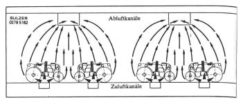
Abbildung 6 Luftströmung in einem Raum mit Arbeitszonenklimatisierung
