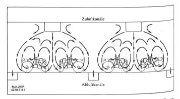
Abbildung 3 Luftströmung im konventionell klimatisierten Raum
