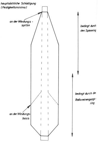
Abbildung 1 Zuordnung der Garnschädigung zum Entstehungsoft
