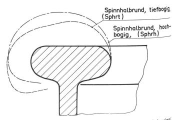
Abbildung 3 Geometrische Verhältnisse im Bereich Spinnring Läufer.
