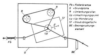
Abbildung 4 Prinzip der Abriebmessung («Staff-Methode»).
