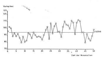
Abbildung 2 Porosität des kalibrierten Papieres über die Breite von 220 cm
