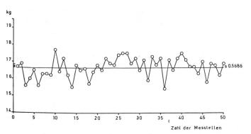
Abbildung 3 Bruchlast längs über die Breite von 220 cm
