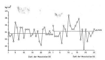
Abbildung 5 Berstdruck nach Schopper-Dalén über die Breite von 220 cm
