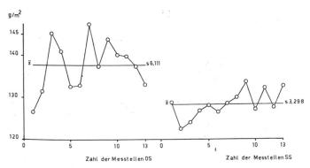
Abbildung 10 Cobb-Test über die Breite von 220 cm
