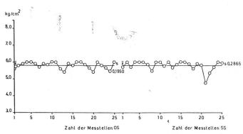
Abbildung 4 Berstdruck nach Mullen über die Breite von 220 cm
