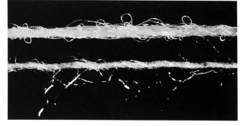
Abbildung 2 Diolen GV Filamentgarn 150 dtex f72 ×1 (oben) im Vergleich zu einem Spinnfasergarn 143 dtex (unten)
