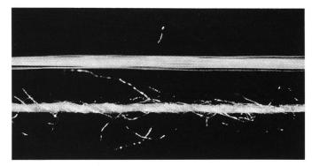
Abbildung 1 Glattes Filamentgarn im Vergleich zu einem Spinnfasergarn
