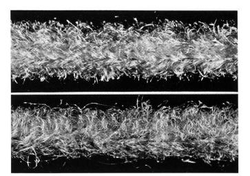
Abbildung 12 Wirksamt aus normalem Diolen-Filamentgarn (oben) im Vergleich zu einer Qualität aus Diolen XF (unten)
