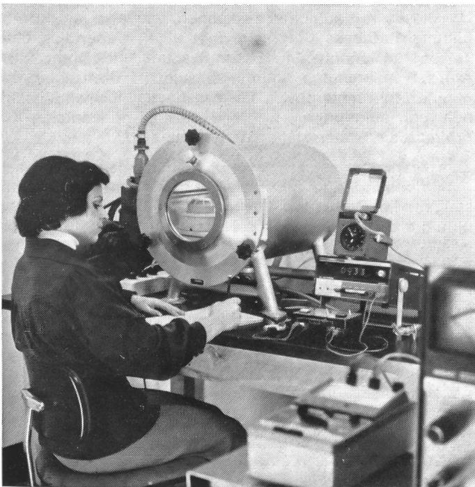
Ein Windkanal gestattet, das einwandfreie Funktionieren von Meldern auch bei Windgeschwindigkeiten bis 20 m/s zu testen. Für den Einsatz von Meldern in Klima- und Ventilationsanlagen, wie sie heute in allen modernen Bauten und namentlich in der Textilindustrie und den Prozessrechner-Anlagen verwendet werden, ist eine solche Prüfung von wesentlicher Bedeutung.
