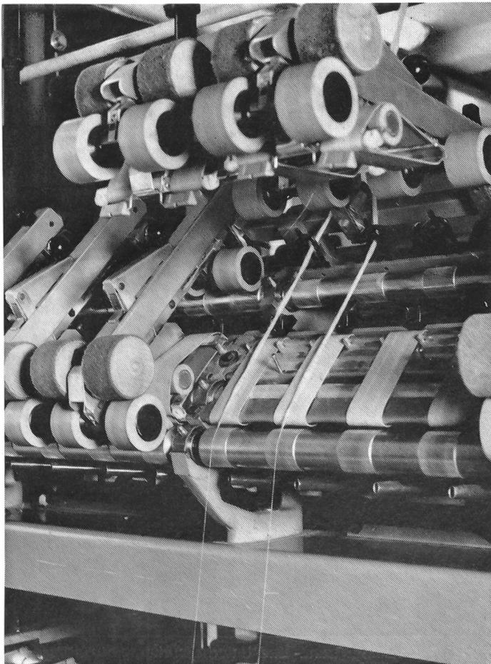
Langstapel-Streckwerk K2R-M für ein erweitertes Einsatzgebiet
