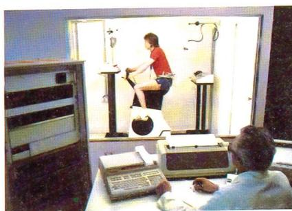
**Abb. 9** Kontrollierter Trageversuch von Sporthemden im Klimaraum; Ergometerstand mit Prozeßrechner
