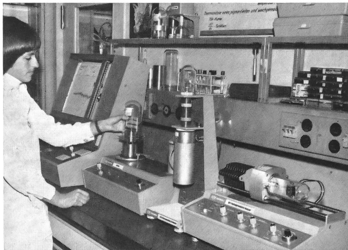
Abbildung 5 Differentialthermoanalyse, insbesondere auch zur Erfassung von Wärmetönungen. Die Apparaturen von links nach rechts: Registriergerät, Mikrokalorimeter für Wärmetönungen, Thermomechanical Analyzer zur Feststellung von Volumen oder Längenänderungen in Abhängigkeit von der Temperatur und Thermogravimetric Analyzer.
