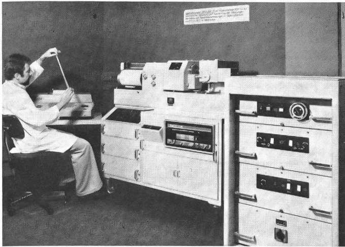
Abbildung 4 Apparatur zur Farbmessung mit angebaute Rechner. Die farbige Probe wird spektral abgetastet und darauf werden die farbmessung relevanten Daten errechnet und ausgedruckt.
