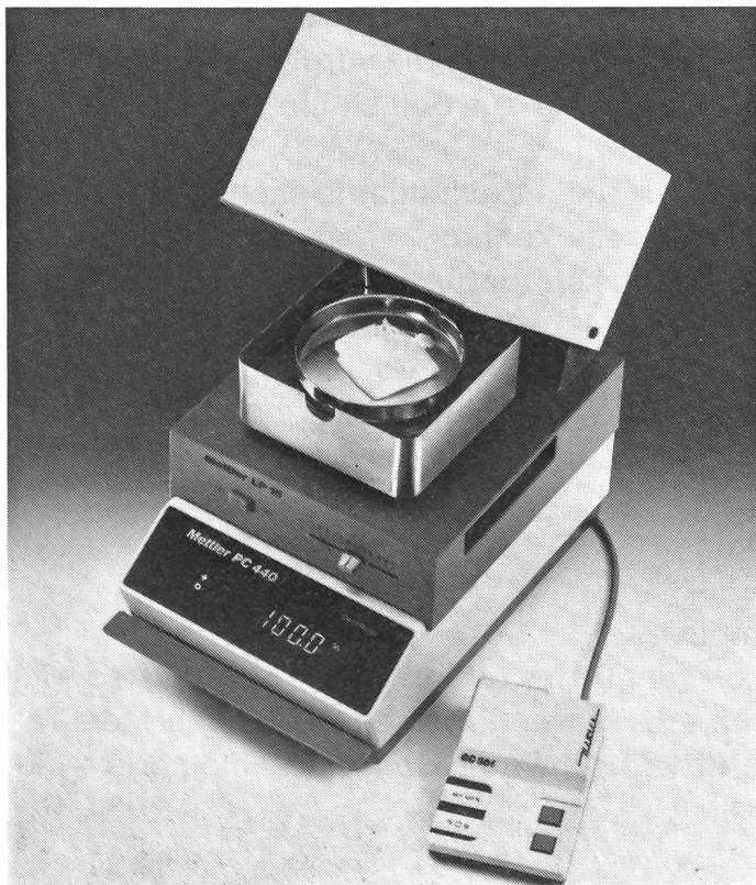
Abbildung 1 Feuchtigkeitsgehalte in Prozenten bestimmen
