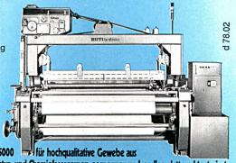
Luftdüsenwebmaschine RÜTI te Strake L5000 Natur- und Chemiefasergarnen, gesponnen und endlos, glatt und texturiert.
