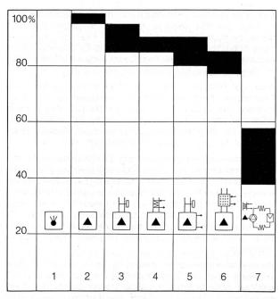
Energiesparmöglichkeiten verschiedener Gasheizsysteme (schwarz) für gleiche Heizleistung bezogen auf Oelheizung. 1 = 100 % Brennstoffverbrauch. 2 Normaler gasgefeuerter Kessel. 3 Gaskessel mit Abgasklappe. 4 Gasgefeuerter Kessel mit Abgaswärmerückgewinnung im Bereich des unteren Heizwerts. 5 Gaskessel mit Abgasklappe und gleitender Fahrweise. 6 Abgaswärmerückgewinnung bis zum Taupunkt. 7 Gas-Wärmepumpe. Bei Kombination verschiedener Massnahmen verändern sich die Prozentzahlen.
