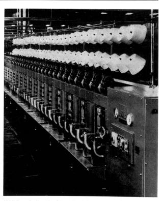
Abbildung 1 Hacoba-Garnschrumpf- und -bausch-Maschine, Modell HB
