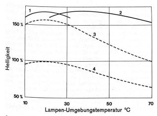
Osram bietet unter dem Namen «Lumilux» eine neue Generation von Fluoreszenzlampen an, die sich durch eine bisher nicht erreichte Lichtausbeute und Farbwiedergabe auszeichnen. Das Diagramm zeigt den über einen weiten Temperaturbereich möglichen Helligkeitszuwachs: 1=Lumilux, 2=Lumilux «In», 3=bisherige Standard-Lichtfarben, 4= bisherige de Luxe-Lichtfarben.
