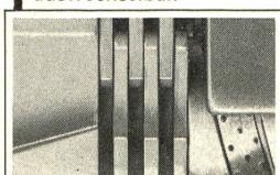
Dieses Kontrollloch ermöglicht eine schnelle und sichere Einstellung des Breithalters.
