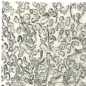
Abb. 9, 10 Vergleich von Gewebequerschnitten im Fluoreszenzmikroskop (90:1). Schnitt durch die Gewebekante, wo der Aufheller auf der Faseroberfläche sitzt (Abb. 9) und durch die Mitte des Gewebes (Abb. 10).
