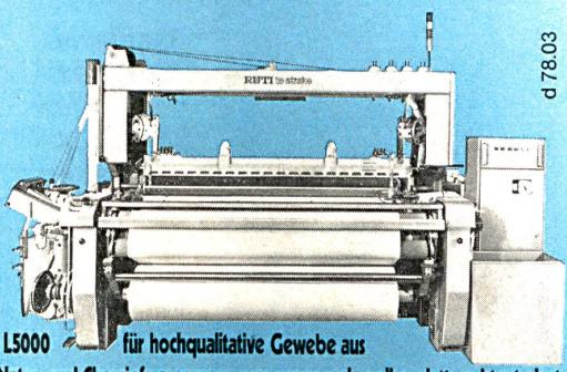
Luftpüsenwebmaschine RÜTI te Strake L 5000
