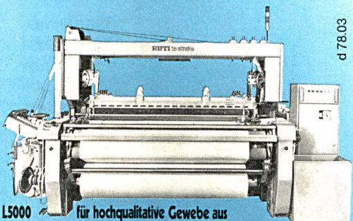
Luftpüsenwebmaschine RÜTI te Strake L5000
