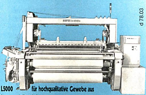
Luftpüsenwebmaschine RÜTI te Strake L 5000
