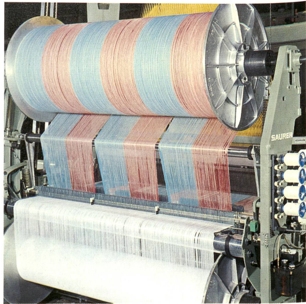
Das Kettablass-System der «terry-matic»-Frottierwebmaschine.
