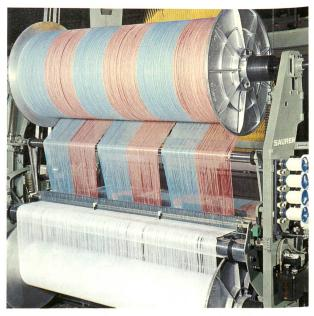
Das Kettablass-System der «terry-matic»-Frottierwebmaschine.
