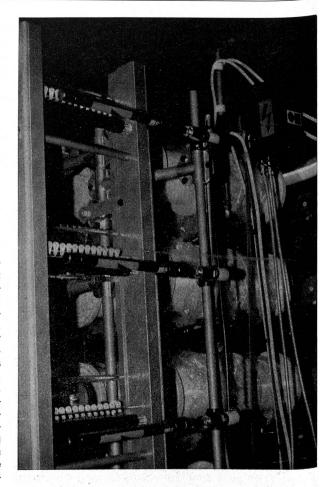
schlechter elektrischer Leiter ist. An den Oesen entsteht also Reibung, die weiterhin durch Umlenkung des Fadens nach dem Auslauf aus der Oese, zu erhöhter statischer Elektrizität führt.
