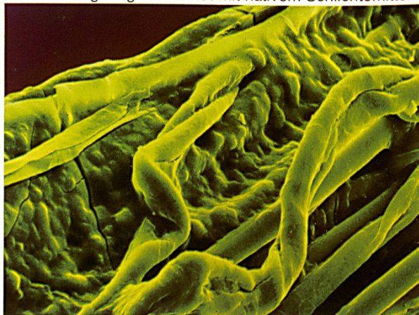
Abb. 3: Kettgarn geschlichtet mit nativem Schlichtemittel
