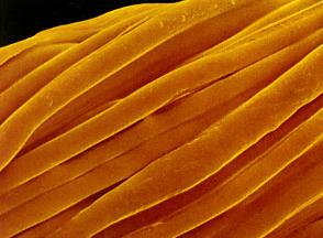
Abb. 3: Kettgarn geschlichtet mit nativem Schlichtemittel
