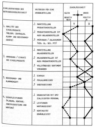
Abbildung 1 Zuverlässigkeit von zwei Sicherheitssystemen (X/Y)
