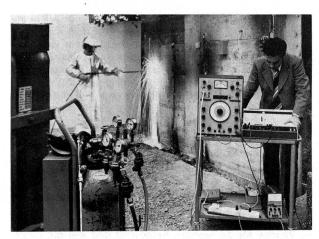
Abbildung 2 Praxisnahe Untersuchungen und Tests sind die Basis für die Entwicklung und dauernde Verbesserung der Produkte und deren korrekten Einsatz. Im Bild werden Auswirkung und Frequenzspektrum der Sauerstofflanze auf Eisenbetonmauern analysiert.
