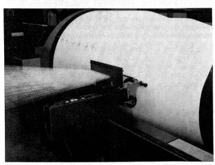
Abbildung 2 Schärsupport mit Steuer- und Messwalze
