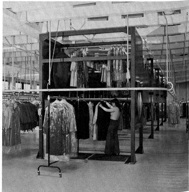
Abbildung 9 Kleiderrotor
