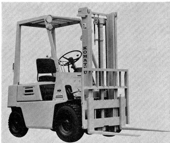
Nach einer fünfjährigen Entwicklungsperiode hat der japanische Komatsu-Konzern eine von Grund auf neu konzipierte Baureihe von Frontgabelstaplern vorgestellt, die bezüglich Betriebssicherheit, Leistungsfähigkeit und Handhabung einen gleichermassen positiven Eindruck hinterlässt. Unser Bild zeigt den Typ Komatsu FG 15 T-11 mit Verbrennungsmotor und 1,5 t Tragkraft. Foto: Hulftegger, Stäfa.
