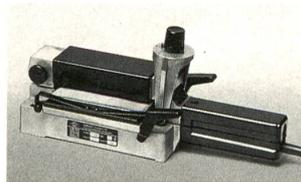
Heizpresse P-100 für minutenschnelles Endverbinden. Nutzbreite: 100 mm.
