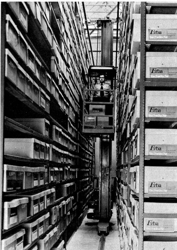
Abbildung 5 Regalbediengerät «Decombi» in einem Wäschelager
