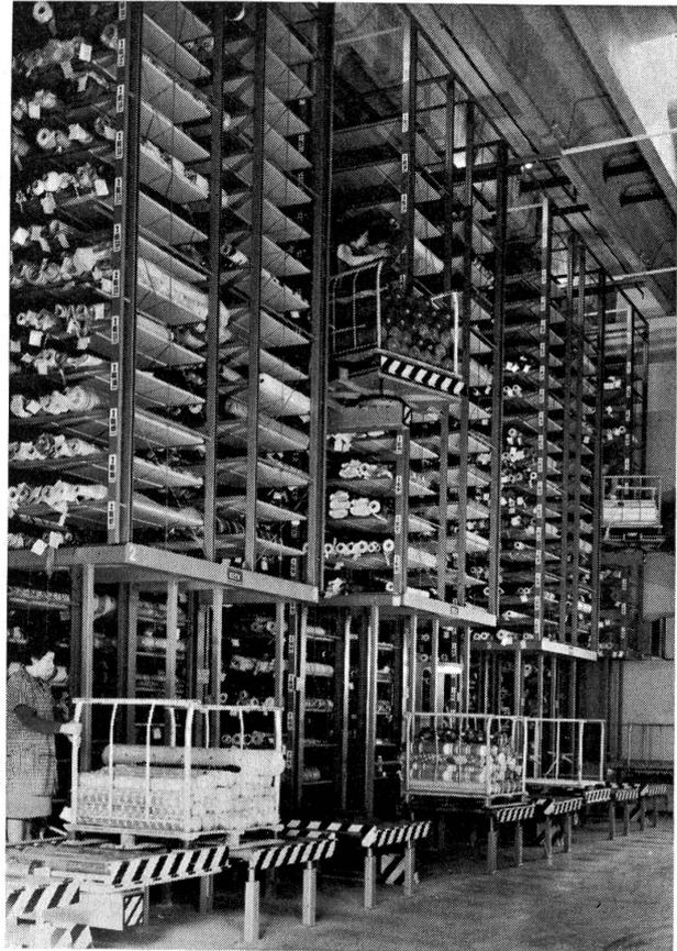
Abbildung 8 Regalbediengerät «Destamat» in einem Stoffballenlager
