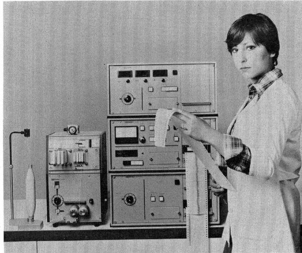
Die neue Gleichmässigkeitsprüfanlage Uster Tester I, Modell B, für Bänder, Vorgarne und Garne aus Stapelfasern.
