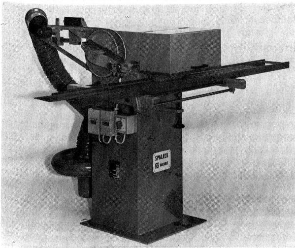
Abbildung 3 Webeblattbürstmaschine mit Zusatzgerät zum Abrichten von Webschützen
