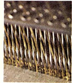
Detail einer der Enka Tuftingmaschinen
