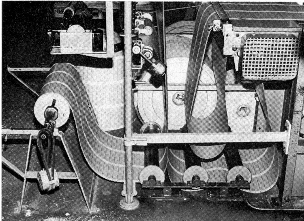
In einem komplizierten Verfahren werden Steuerpapiere mass stabil gemacht und mit der erforderlichen Transportlochung versehen.
