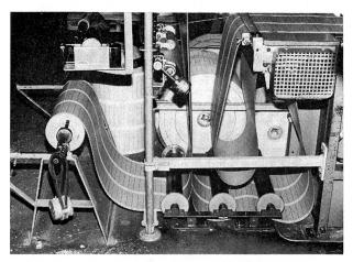
In einem komplizierten Verfahren werden Steuerungspapiere massstabil gemacht und mit der erforderlichen Transportlochung versehen.
