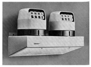
Zwillingsausführung einer modernen Zerstäubungsanlage in einem Spinnereibetrieb. Die Geräte arbeiten mit 220 V-Wechselstrom und sind aus korrosionsfestem Material gefertigt. Grossflächige Filtereinbauten entfernen Staub und Fasern aus der angesaugten Raumluft. (Werkbild Defensor)
