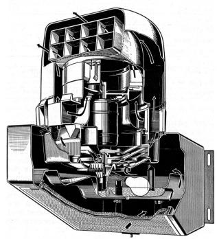
Beim Zerstäuber – hier ein Schnittbild – wird das ankommende Wasser durch schnellaufende Schleuderscheiben in feinste Tröpfchen zerrissen. Diese Aerosole verdunsten aufgrund ihrer grossen Oberflächenspannung spontan und vermengen sich gleichförmig mit dem Luftstrom. (Werkbild Defensor)
