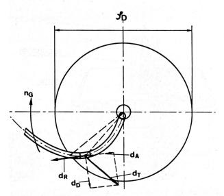
Abbildung 2 Reibkräfte zwischen Garn und Abzugdüse
