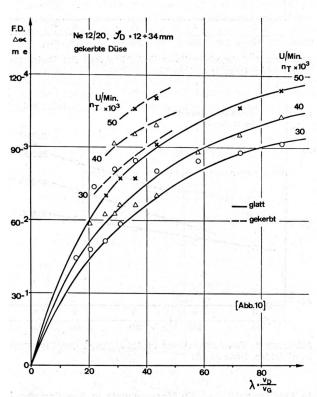
Abbildung 10 Falschdrahteffekte in Abhängigkeit des Geschwindigkeitsverhältnisses  $\frac{v_D}{v_G}$
