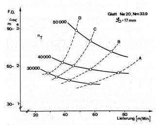
Abbildung 5 Falschdrahtwirkung bei glatter Düse, Baumwollgarn Ne 20, in Abhängigkeit der Garnliefergeschwindigkeit
