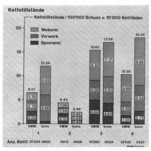
Abbildung 11 Kettstillstände pro 100 000 Kettfäden und 100 000 Schuss
