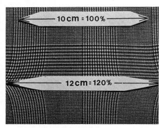
Abbildung 3 Comfort-Stretch 20 % Schussdehnung (Polyester text. 167 dtex f 36)
