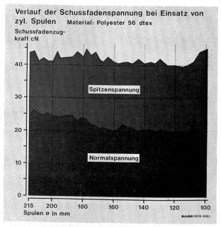
Abbildung 7 Verlauf der Schussfadenspannung bei Einsatz von zyl. Spulen
