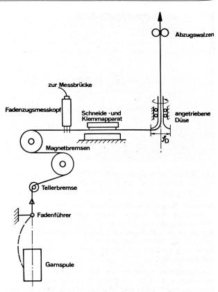
Abbildung 3 Schema der Versuchseinrichtung
