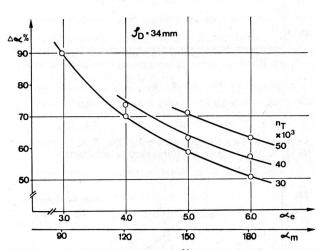
Abbildung 11 Falschdrahteffekt in % der nominellen Drehung in Funktion vom Drehungskoeffizienten und der Rotordrehzahl
