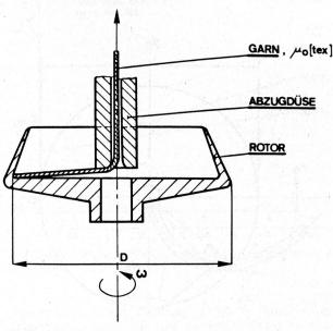
Abbildung 1 Verhältnisse im einfachen Spinnrotor
