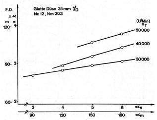
Abbildung 8 Falschdrahteffekte in Abhängigkeit des Drehungskoeffizienten, Düse 34 mm
