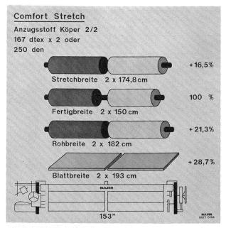
Abbildung 5 Breiteneinstellung bei Comfort-Stretch
