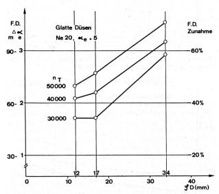
Abbildung 9 Falschdrahteffekt in Abhängigkeit des Düsendurchmessers
