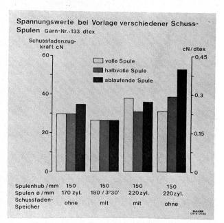
Abbildung 8 Spannungswerte bei Vorlage verschiedener Schuss-Spulen
