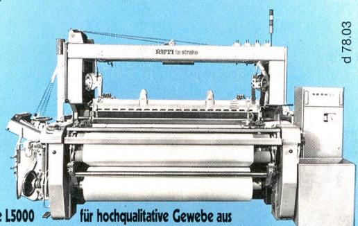
Luftpüsenwebmaschine RÜTI te Strake L5000 für hochqualitative Gewebe aus Natur- und Chemiefasergarnen, gesponnen und endlos, glatt und texturiert.
