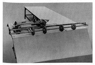
Abbildung 1 Diese neuentwickelte Zusatzeinrichtung für Bahnennähmaschinen erleichtert die Konfektion von Markisen, Segeln, Fallschirmen, Polierscheiben und Filtertüchern, Traglufthallen und leichten Flächentragwerken. (Werkfoto Schips)
