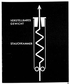
Abb. 6 Schematische Darstellung des Stauchkammer-Verfahrens.
