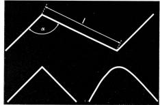
Abb. 5 Die morphologischen Merkmale einer Zickzackstruktur: α, I und Ausbildung des Knicks
