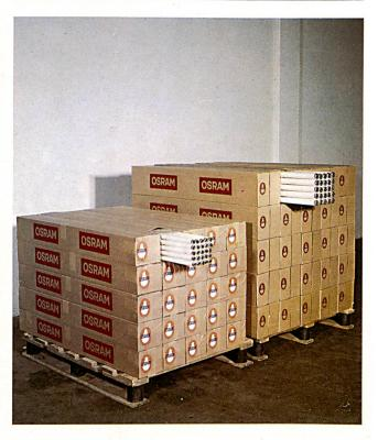
Das Volumen der Palette mit 26 mm  $\phi$  beträgt 0,86 m³, mit 38 mm  $\phi$  dagegen 1,5 m³.
