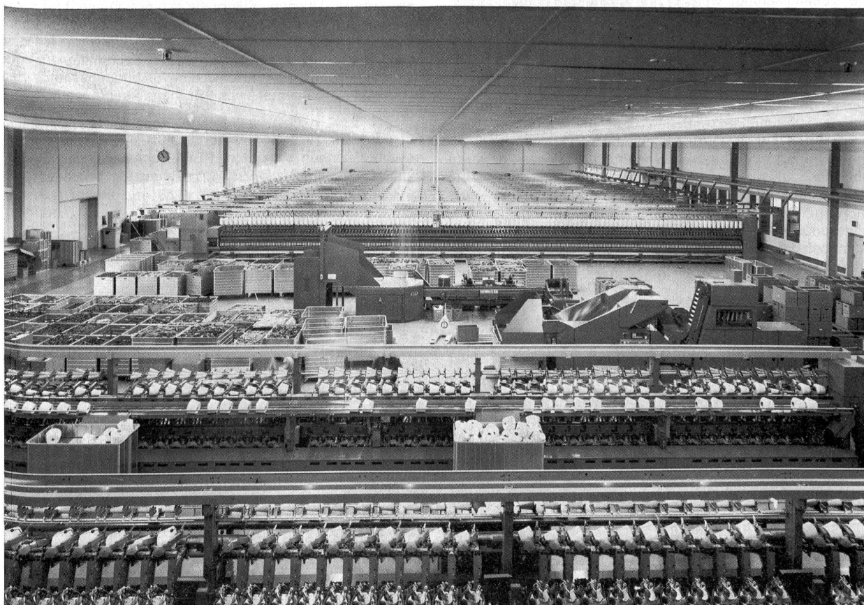
Der neue Ringspinnmaschinenaal mit den dazugehörigen Spulautomaten
