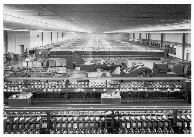
Der neue Ringspinnmaschinensaal mit den dazugehörenden Spulautomaten
