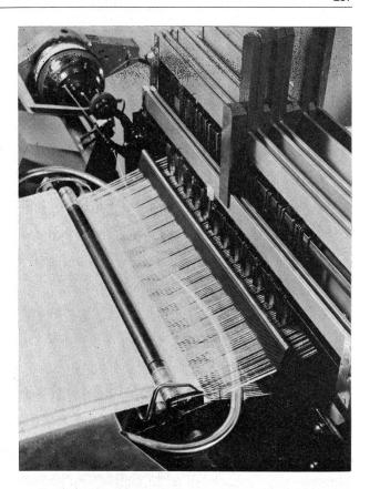
Anlässlich der internationalen Textilmaschinenausstellung im Oktober 1975 in Mailand wurde der für breite Bänder gebaute Webautomat «NCE» der Oeffentlichkeit vorgestellt. Die Maschine wird in den Blattbreiten 280 und 365 mm gebaut. Die Typenbezeichnungen sind NCE 1/280 und NCE 1/365.
