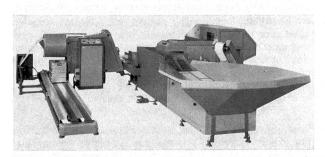
Hülsensortier- und Reinigungsmaschine Modell RT3 mit Estrafil 1F/UN
