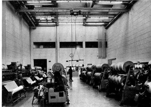
Abbildung 4 Einträger-Hängekran zum Kalanderttransport
