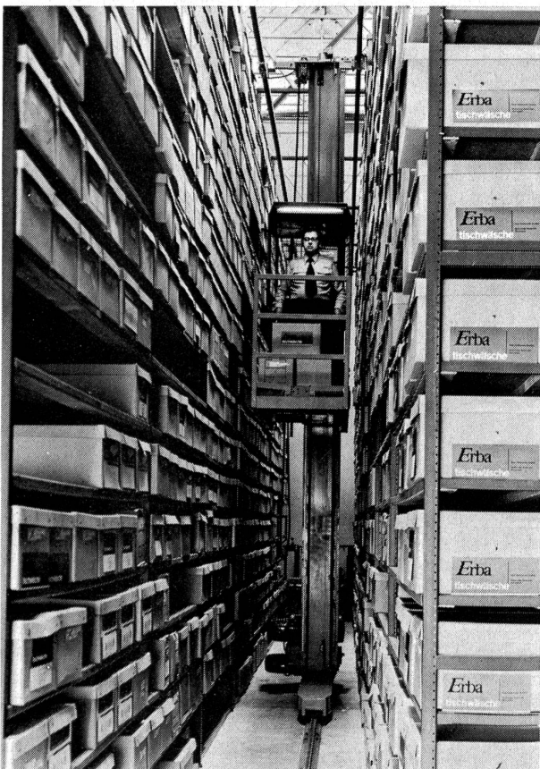
Abbildung 5 Regalbediengerät «Decombi» in einem Wäschelager
