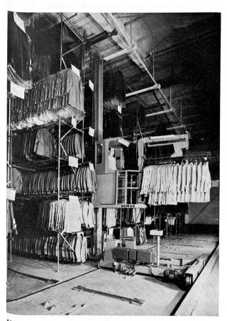
Abbildung 7 Regalbediengerät «Decombi» in einem Kleiderlager
