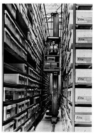
Abbildung 5 Regalbediengerät «Decombi» in einem Wäschelager
