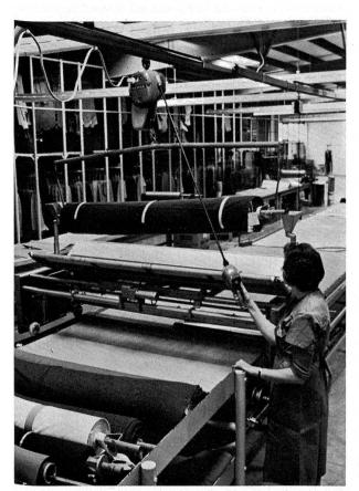
Abbildung 3 KBK-Hängebahn über Stofflege-Automaten
