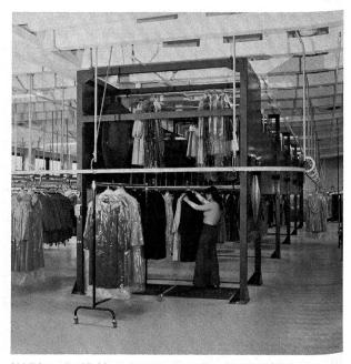
Abbildung 9 Kleiderrotor
