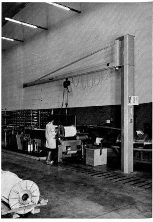
Abbildung 2 KBK-Säulenschwenkkran über Schärmaschinen
