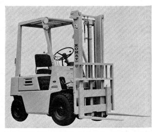
Nach einer fünfjährigen Entwicklungsperiode hat der japanische Komatsu-Konzern eine von Grund auf neu konzipierte Baureihe von Frontgabelstaplern vorgestellt, die bezüglich Betriebssicherheit, Leistungsfähigkeit und Handhabung einen gleichermassen positiven Eindruck hinterlässt. Unser Bild zeigt den Tpy Komatsu FG 15 T-11 mit Verbrennungsmotor und 1,5 t Tragkraft. Foto: Hulftegger, Stäfa.
