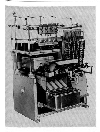
werden. Diese Vorrichtung kann ausserdem so gestaltet werden, dass bei Ueberschreitung einer vorwählbaren Fadenspannung der Wickelvorgang gestoppt wird. Dies bedeutet eine weitere Erleichterung für das Bedienungspersonal und vermeidet Störungen im Produktionsablauf.
